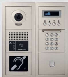
GTBVH (200274) Platine vidéo accessibilité avec boucle magnétique Dim : 320 x 270 x 16 mm Encast : 295 x 245 x 44 mm Boîtiers d'encastrement GF3B x 2 non inclus
