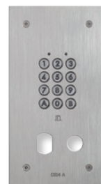
CIE4A (120192) Clavier inox encastré avec perçage pour VIGIK® Perçage pour canon résidant diamètre 19 mm livré sans obturateur
